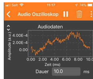
Abbildung 1.10: Das Audio Oszilloskop zeichnet die Amplitude zur Zeit auf.
