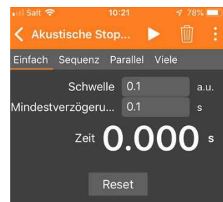
Abbildung 1.15: Die Akustische Stoppuhr im Modus Einfach kann mit dem ► Symbol gestartet werden.
