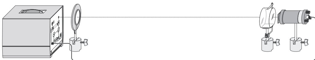
Abbildung 1.5: Optischer Aufbau zur Bestimmung der Lichtgeschwindigkeit in Glas.
