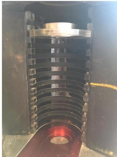
Abbildung 1.10: Platziere die transparente Probehalterung mitsamt der gefüllten Messschale in einer oberen Position im Messraum. Während der Messung ist die Bleitüre des Messraums immer geschlossen zu halten.
