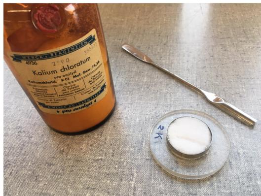
Abbildung 1.9: Kaliumchlorid wird in die inaktive Messschale bis zum Rand gefüllt. Hierfür ist ein Spatel zu verwenden. Trage Handschuhe und arbeite vorsichtig, um nichts zu verschütten. Die Messschale ist danach in einer transparenten Probenhalterung zu platzieren.
