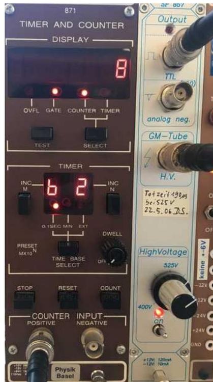
Abbildung 1.8: Das braune Modul links ist ein Zähler, das silberne rechts ist die Hochspannungsversorgung für das Zählrohr. Um die Hochspannung einzuschalten ist ganz rechts der Hauptschalter auf *ON* zu bringen und dann die Hochspannung unten im silbernen Modul ebenfalls auf *ON* zu stellen. Es sollte ein Wert von 580 V eingestellt sein. Das Output Signal ist mit dem Counter zu verbinden. Die Totzeit beträgt des Zählrohrs beträgt rund 190  $\mu$ s.
