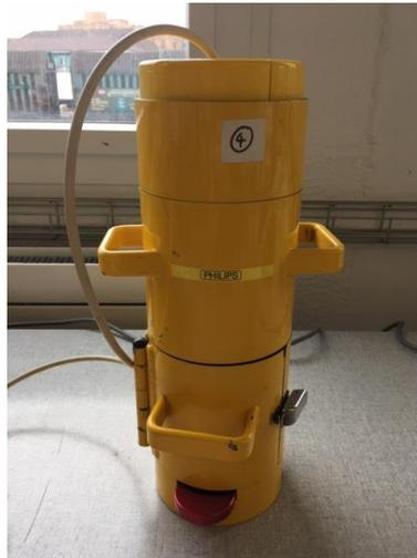
Abbildung 1.5: Für die Bestimmung der Halbwertszeit von  $^{40}\text{K}$  wird ein PHILIPS Zählrohr verwendet. Dieses ist mit Blei ummantelt. Im unteren Bereich befindet sich die Messkammer, in welche die Proben eingeführt werden können.
