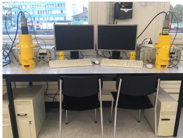
Abbildung 1.7: In diesem Versuch werden NaI-Detektoren (gelb) für die Gammaskopie verwendet. Diese werden über eine externe Spannungsversorgung (hinter den Detektoren) betrieben. Ein weiteres Modul sorgt für die Verstärkung des Signals, bevor dieses vom Computer aufgezeichnet wird.
