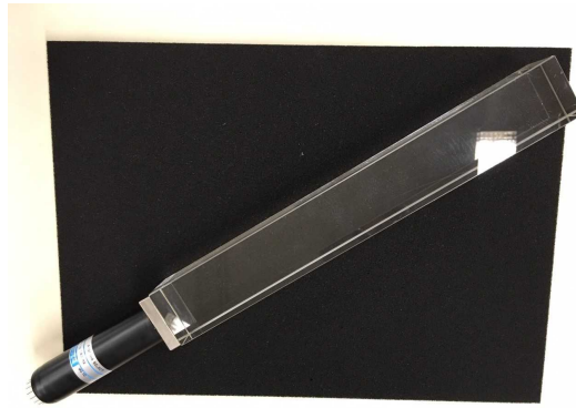
Abbildung 1.8: Ein quaderförmiger Szintillatorkristall ist an einen Photomultiplier (unten links) angebracht. Der besseren Sichtbarkeit wegen befindet sich der Kristall für das Foto auf einem schwarzen Blatt Papier. Es handelt sich hier um ein Symbolbild, der Kristall stammt aus einem Experiment am Paul Scherrer Institut (PSI) in Villigen.
