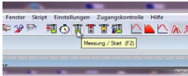
Abbildung A.10: Mit der grünen Ampel kann die Messung gestartet werden, die rote Ampel stoppt die Messung und die orange Ampel setzt das Spektrum zurück.
